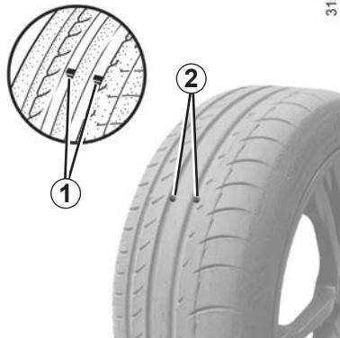
Шины должны быть в исправном состоянии, а протектор должен иметь достаточную глубину рисунка; шины, отвечающие требованиям компании-производителя, имеют специальные выступы-индикаторы износа 1, которые отформованы на беговой дорожке колеса.
