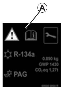
В холодильном контуре кондиционера (некоторые части которого герметично изолированы) содержится хладагент, при испарении которого выделяются фторсодержащие парниковые газы.
