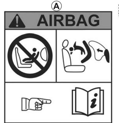
Об этом же напоминает маркировка на приборной панели и этикетки **A** с обеих сторон противосолнечного козырька **3** (образец этикетки показан выше).
